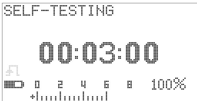
Figure 5-2 Affichage de la durée d'autotest
